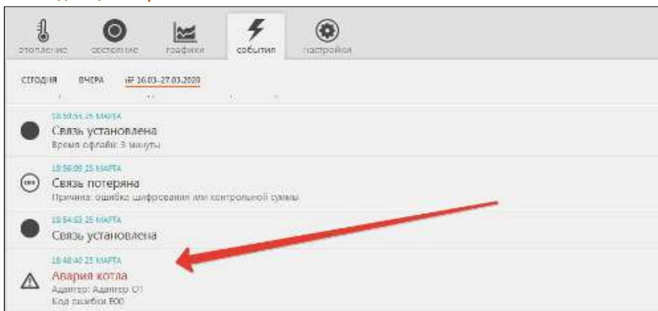
Для индикации аварии котла при релейном способе управления, используется свободный аналоговый вход Контроллера. Сигнал “авария”, снимается с клемм котла и подается на аналоговый вход Контроллера.
